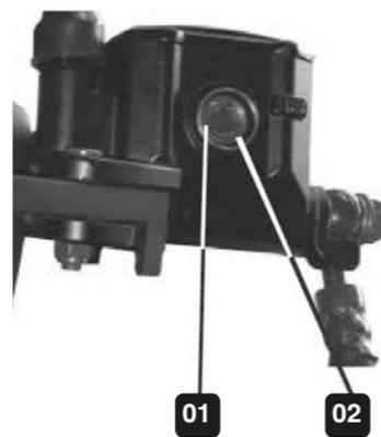
Compruebe si el nivel de líquido de frenos está por encima de la marca **LOWER** (2) a través de la mirilla (1). En el caso de que el nivel se encuentre por debajo de la marca, necesitará añadir líquido de frenos, superando esta marca en 3 - 5 mm. En este caso compruebe también si el desgaste de las pastillas está dentro de los límites.
