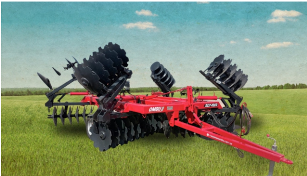
Rastra en posición de transporte, alas rebatibles.
