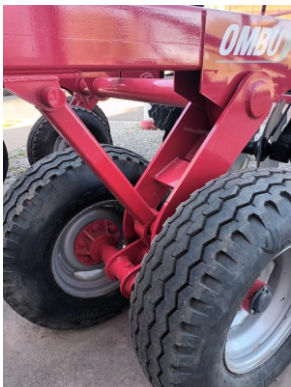
Sistema de trabas para transporte.
