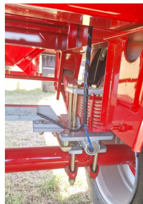
Eje delantero y suspensión. Opcional: Balanza.
