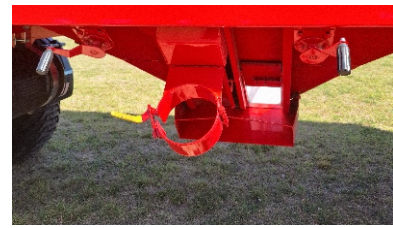
Nuevo sistema de apertura boquilla, con piñón y cremallera.
