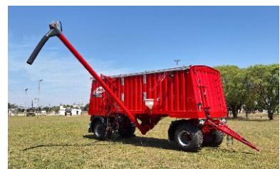
Sistema de descarga. (adaptable a sembradoras Air drill)
